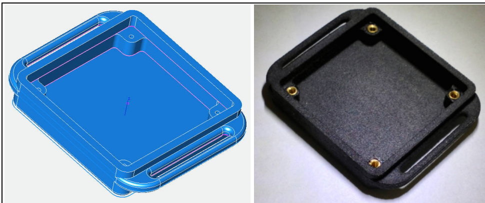
Abb. 2: Uhrengehäuse, links: Entwurf mit 3D-Konstruktionssoftware, rechts: per 3D-Druck im Laser-Sinterverfahren hergestelltes Gehäuse inkl. vier eingeklebter Gewindebuchsen.
