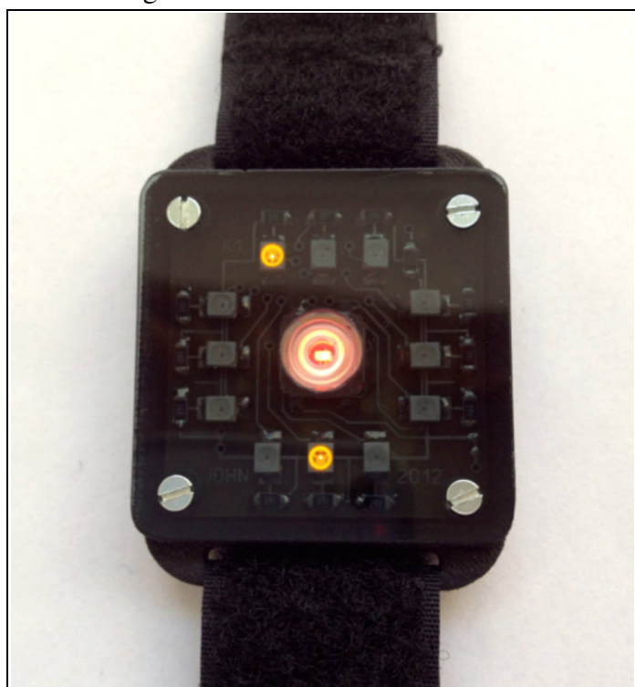
Abb. 3: Foto der kompletten LED-Armbanduhr mit aktivierter Zeitanzeige (in dem Moment, in dem auch die blinkende Minuten-LED gelehuchtet hat).
